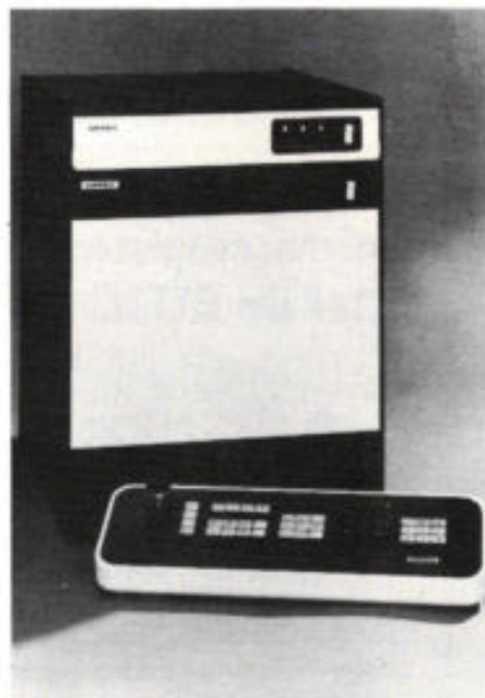
Afb. 6. Het ADO digitale effecten apparaat.
