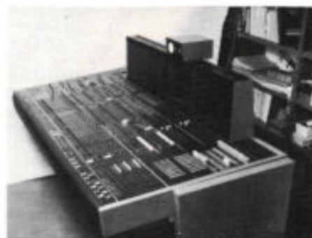
CATV-gebied. De Hongaren (Electroimpex) toonden een heel omvangrijke en mooie regietafel, waarbij gebruik gemaakt wordt van vele lichtdiode arrays, op de foto helaas niet te zien. We vermelden tot slot dat op de stand van onze NKF, ook een Philips-kabel-dochter een bijzonder instructief filmpje werd getoond over het lassen van glasaders. NKF heeft daarvoor een klein maar doeltreffend apparaat ontwikkeld, waarmee glasvezels in een kabel stuk voor stuk afgeïsoleerd en gelast worden; door de microscoop, vast opgebouwd op het werktafeltje, kon men door middel van coördinaten tafeltje-met-schroef de beide vezelenden eerst recht tegenover elkaar en in de laatste fase vlak tegen elkaar aanbrengen, waarna een vlamboog de eindjes zodanig aan elkaar smelt dat de verliezen nihil zijn. En dat alles in een klein, handig kistje.
