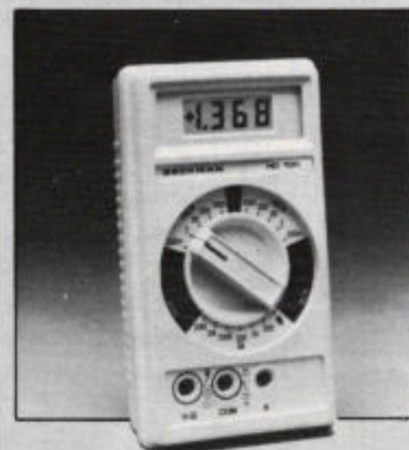
Klein, zeer robuust en heldergeel is de nieuwe digitale multimeter HD100 van Beckman Instruments. Het instrument kan ingangsoverbelasting tot 1500 V gelijkspanning of 1000 Veff. verdragen en is beschermd tegen transiente spanningen tot 6 kV gedurende 10 \mu s. Andere eigenschappen: waterdicht, bestand tegen schokken en trillingen, 3 1/2-digit LCD-uit-eizing, 9 V-batterij (2000 uur bij alkaline, 1600 uur bij zink), gelijkspanningsnauwkeurigheid 0,25% van aflezing \pm 1 digit.
