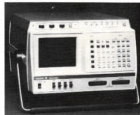
Afb. 14. Op basis van de logic analyzer K100-D construeerde Gould-Biomation de Communicator T12. Twee van deze instrumenten kunnen via het telefoonnet communiceren, waardoor diagnose van defecten in digitale apparatuur „op afstand” kan geschieden.
