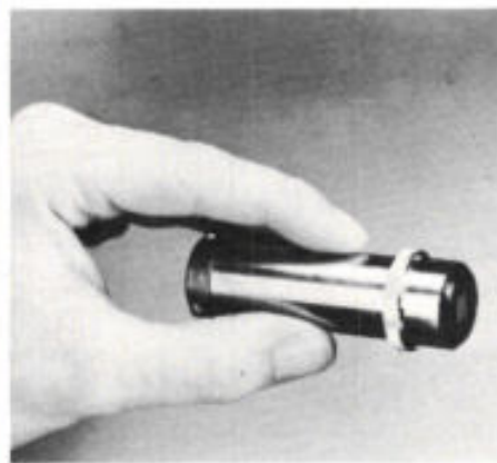
Afd. 4. Lichtgewicht Plumbicon 80XQ met laag vermogenverbruik.
